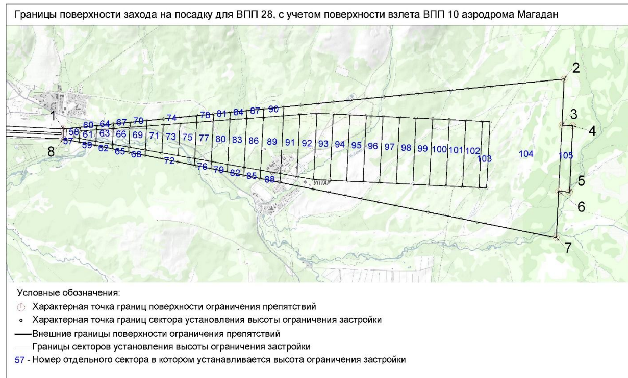
Рисунок 4.4. Схема границ поверхности захода на посадку для ВПП 28, с учетом поверхности взлета ВПП 10
